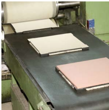
Auftragung der Klebeschicht und Zusammenführen der Keramik-Fliesen
